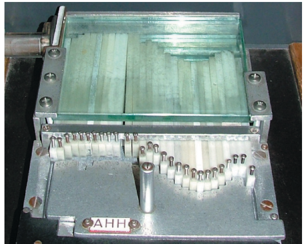
図-2 Exploratorium の声道模型
