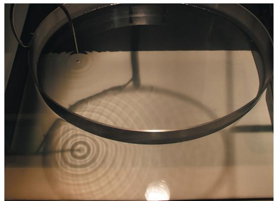
図-3 水面波を利用した、楕円形内部での波の伝搬を体験できる装置
