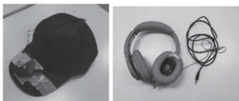
Fig. 1 帽子型骨伝導イヤホン (左) 及びヘッドホン型骨伝導イヤホン (右)。軟骨伝導振動子をそれぞれのマテリアルに粘着テープで貼り付けている。
