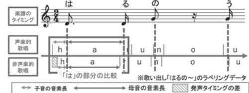
Fig1.音素長と発声タイミングの比較例:歌い出しの「は」の部分
